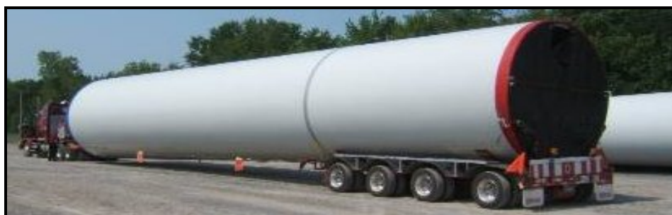
Figura 3.7. Transporte de uma seção da torre. Fonte: BRASELCO, 2010.
