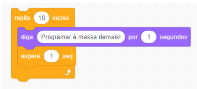
Figura 1.97: Estrutura de repetição com quantidade de repetições determinada por digitação direta.
