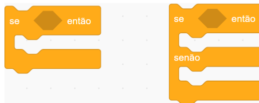
Figura 1.32: Blocos de instruções para estruturas de decisão.
