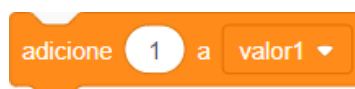
Figura 1.47: Bloco de instrução para atualizar o valor de uma variável. No caso da Figura, a variável de nome “valor1” terá seu valor aumentado em uma unidade.
