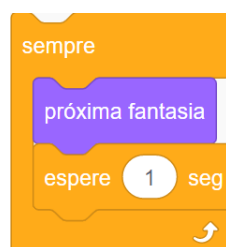
Figura 1.17: Programa montado para trocar de fantasias em repetição indefinida, com um tempo de espera entre cada troca.
