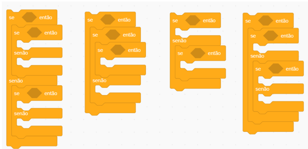
Figura 1.87: Diferentes possibilidades de encadeamento de estruturas de decisão.
