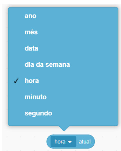
Figura 1.91: Bloco de instrução que obtém a hora atual do computador.
