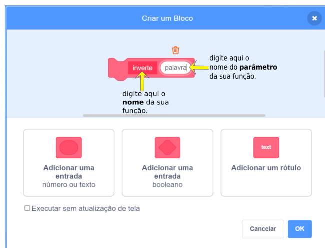
Figura 1.114: Preenchimento do nome do bloco e do nome do parâmetro da função que vai agrupar as instruções referentes à tarefa de inversão de texto, discutida no Exemplo 1.11.
