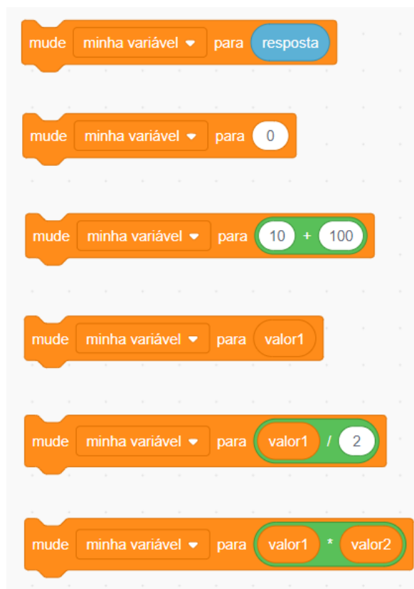
Figura 1.46: Diferentes possibilidades para atribuir valores a uma variável. Nos exemplos, a variável que está sendo atualizada tem o nome “minha variável”.
