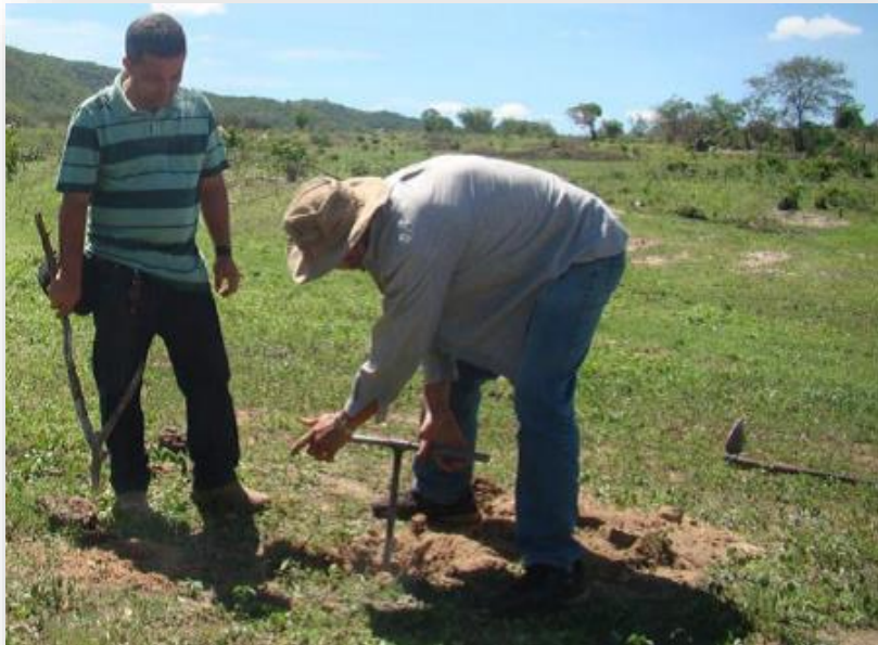
Figura 2: Escolha do local/sondagem
